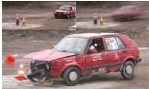
Crashtest bei Straßburg 2005: PKW mit 1000 kg und 50 km/h fährt auf einen vollautomatisch versenkbaren Poller Modell Chateauf (250x500 mm) auf. Nach dem Crash war der Poller voll funktionsfähig und fuhr ohne Beeinträchtigung runter und wieder hoch.
